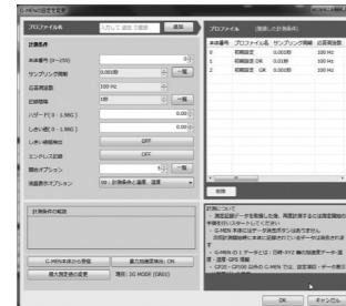
上記の設定ではG-MEN GRの測定開始を実行すると開始オプション5で、USBケーブルを抜いてから、5秒後から始動し1秒で1データを記録します。内容は記録間隔1秒間の中で0.001秒ごとサンプリング計測してそのデータの中でXYZ軸のそれぞれのピークG値を記録し温度・湿度も記録します。
