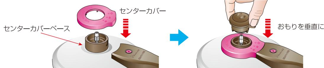
**注意** おもりレバーを、センターカバーのイラストに合わせて取り付けが出来ていないと、正常な圧力がかかりません。また蒸気の出る方向が変わりますので、おもりは必ずセンターカバーのイラストに従って取り付けてください。
