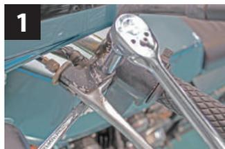
10mm六角ソケットレンチ及びスパナでレバーナットとボルトを外します。
