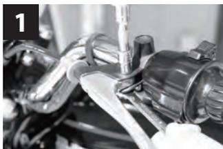
8mm六角ソケットレンチ及びスパナでレバーナットとボルトを外します。
