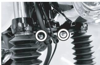
1. 車両本体の純正ボルト(白丸印2箇所)を外します。
