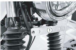
2. 1.で外した部分に①ステー本体を純正ボルトで共締めします。
