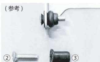
※ウェルナットは写真のように潰れるまで締め込む事で振動防止と緩み止め効果を発揮します。
