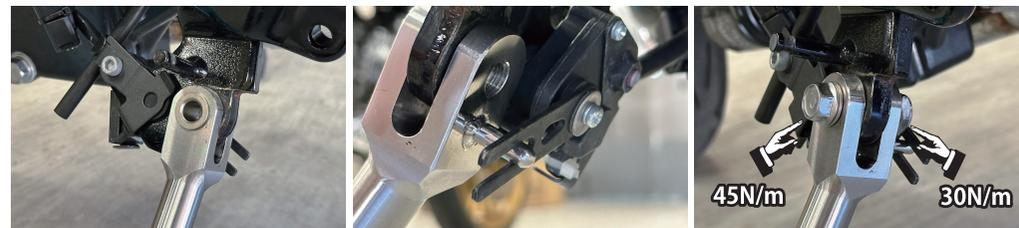
3) スプリングフックを使用して、純正サイドスタンドスプリングを図の方向に取り付けます。
