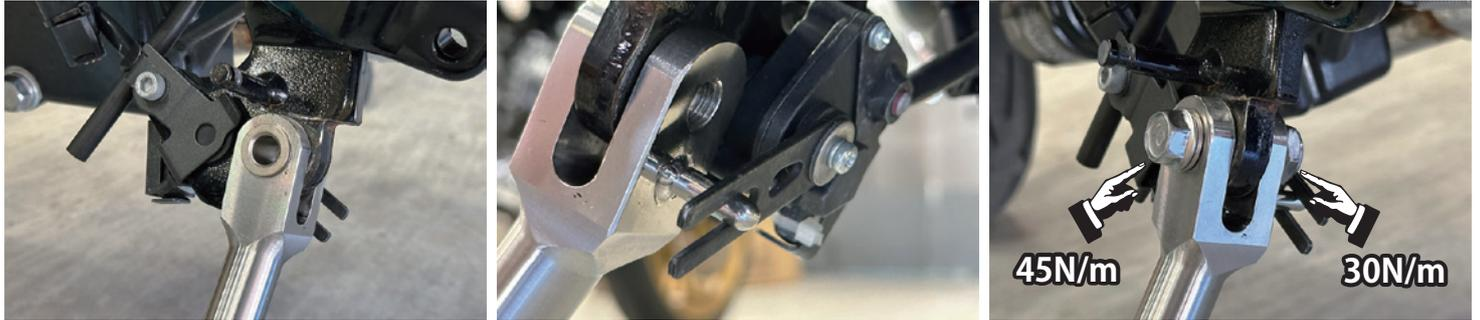
3) スプリングフックを使用して、付属の④サイドスタンドスプリングを図の方向に取り付けます。
