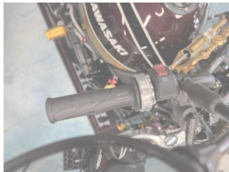
F. 取り外した部分を規定トルクで締め付けスロットルがスムーズに作動するか確認し【完成】となります。
