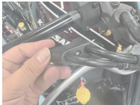
C. ②ロアボディに④ボルトを使用し、ワイヤーをホルダーに固定します。
