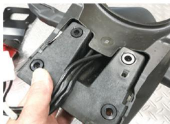
4. ②スペーサーを①マウントの穴にはめ込みます。この②スペーサーがずれないようにしながら車体へセットして、フェンダー Assy を固定して下さい。
