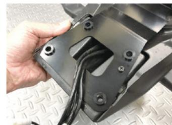
5. 純正のテールランプアッパーステーからダンパーを取り外し、⑤ステーにセットし、テールランプとフレームに固定します。固定は純正と同様に、⑥ボルト・車体側ブラケット・⑤ステー・⑧ワッシャ・⑦ナットの順にセットして固定して下さい。
