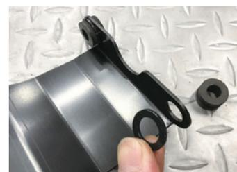
①マウントに④スペーサーをセットして、マウントダンパーを取り付けて下さい。テールランプをセットして、タッピングビスで固定して下さい。
