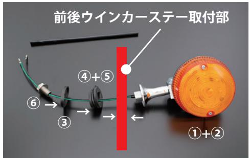
● ウィンカー側オス端子に防水スリーブを付け、車体メインハーネス側と⑦ ウィンカー変換用配線、本製品 LED ウィンカーの配線を同色で接続します。
