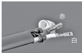
1. ②端子先端に赤 (高照度) 白 (低照度) いずれかを差し込みます。
