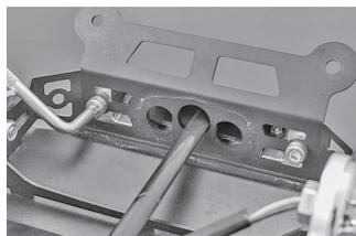
4. ④ボルトでフェンダーレス本体に固定します。(六角レンチ 5mm)
