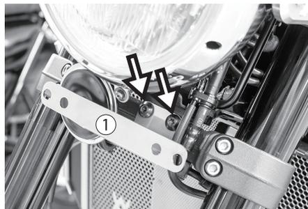
2. 1. で外した部分に①ステーを純正ボルトで共締めします。
