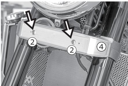
4. ④ステムエンブレムに②丸皿ボルトを差し込み③ウェルナットにねじ込んで固定します。
