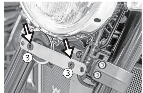
3. 取り付けしたステー内側の穴に③ウェルナットをセットします。
