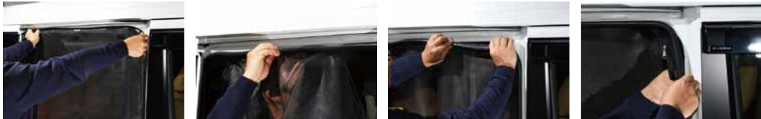
ウェザーストリップを外し、防虫ネットの上部中央から固定して下さい。
