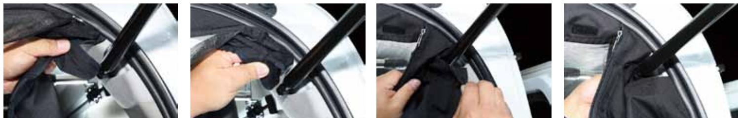
ダンパー部分は袋状になっているので、ドアを開閉しても干渉しないように車内側へ固定して下さい。
