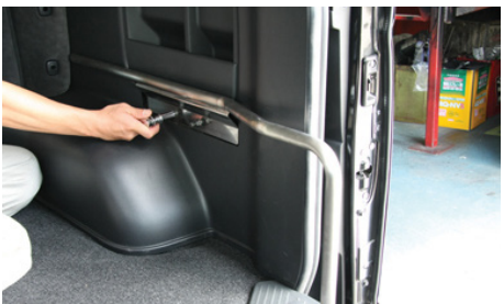
助手席側フレームを仮固定して下さい
