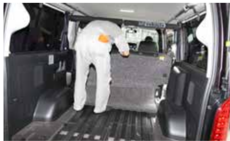
車内より純正のフロアカーペットを外して下さい。
