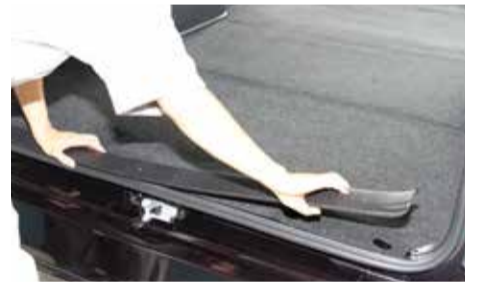
スライドドアステップカバー・エンドカバーを外して下さい。
