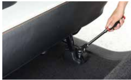
車内よりセカンドシートと荷掛けフック・ボルトを外して下さい。
