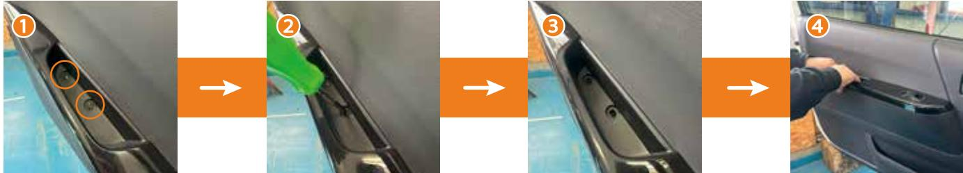
①～③ 助手席側ドアポケットの底面の 2ヶ所のプラスビスを外します。
