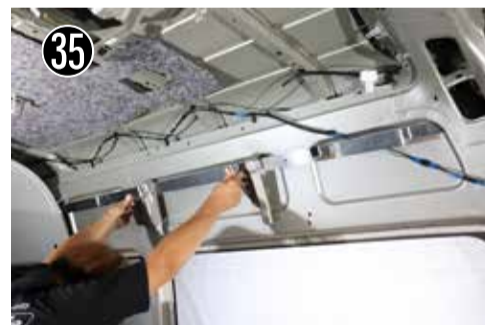
31 ブラケットを大きく切り欠いている方（車両前側）から通していきます。
