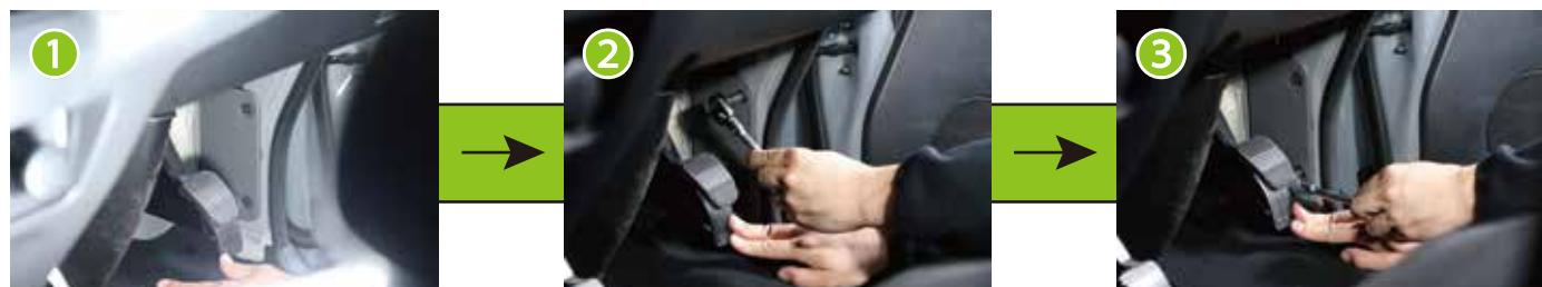
① アクセルペダル右壁のプラスチックカバーを外します。
