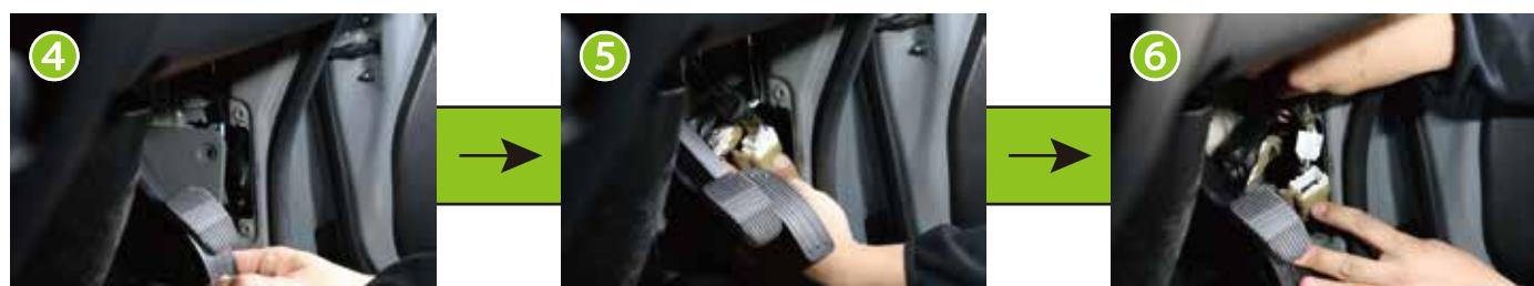
④ プラスチックカバーのツメを外しながら、カバーを外します。
