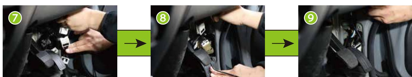
⑦ 10ピンカプラーにミラークローズキット 1 を割り込ませるように取り付けます。
