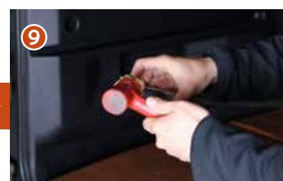
⑧～⑨ ゴムハンマーを使用して、アルミスライドバーにエンドキャップを打ち込みます。
