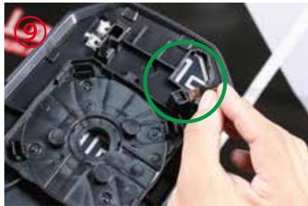
⑦～⑧ \*ミラーヒーター付き車の場合は純正のカプラーをマイナスドライバーやラジオペンチを使用して取り外して下さい。
