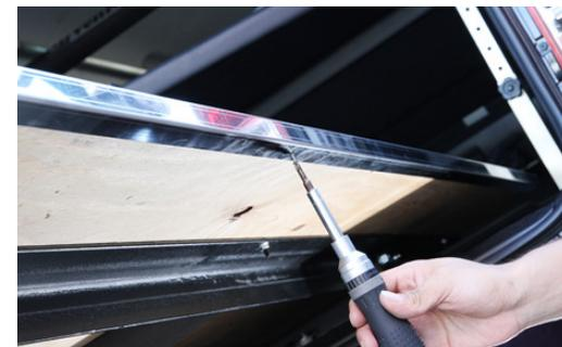
スライドフロアの木口部分にサイドカバーをはめ、裏面からタッピングビスで固定して下さい。両サイド+奥側の3辺に取付けて下さい。
