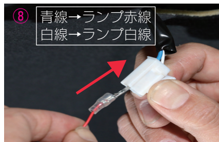
⑧ ③で外したカプラーの青線側に 本体赤線、白線側に本体白線 を取り付けてください。
