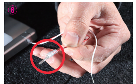
⑤～⑦ 赤線・白線に絶縁スリーブを通して から付属のオス端子を圧着し、 根本部分にスリーブを被せてくだ さい。黒線には、付属のクワ型 (アース) 端子を圧着してください。
