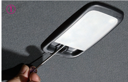
① 細いマイナスドライバー等で レンズカバーを取り外してく ださい。
