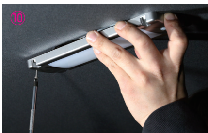
⑩ 純正カーゴランプの取り外し穴が隠れるように 本体の位置を調整し、付属のビス4本で固定し てください。
