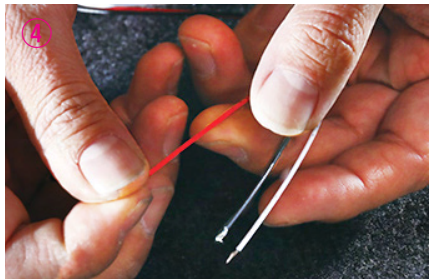
④ 赤線 電源 (バッテリープラス) 黒線 アース (マイナス) 白線 カーテシ (マイナスコントロール)
