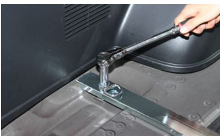
6ヶ所すべてに付属のM8×60mm ボルトを使用して下さい。 M8 ボルト・スプリングワッシャー・平ワッシャーの順で使用して下さい。 純正荷掛けフックと一緒に4ヶ所、純正荷掛けフック無しで2ヶ所固定して下さい。
