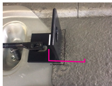
L型固定ブラケットを止める前に一度仮合わせをし、干渉する部分のタールを剥がして下さい。
