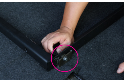
スライドフロア本体を車内に乗せ、 先の手順で固定したブラケット部分と 固定して下さい。
