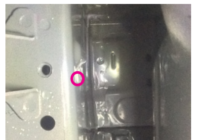
下から覗き、印の位置を目掛けて、長い ドライバーなどで突いて下さい。
