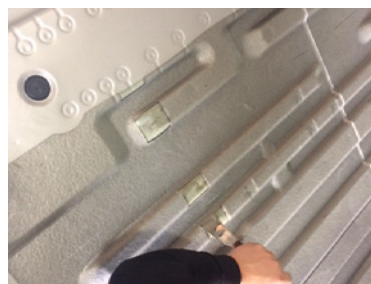
後部用角パイプフレームを仮合わせし、フロアタールと接する部分をマークして下さい。
