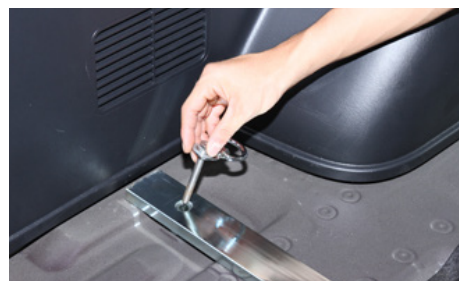
6ヶ所すべてに付属のM8×60mm ボルトを使用して下さい。 M8 ボルト・スプリングワッシャー・平ワッシャーの順で使用して下さい。 純正荷掛けフックと一緒に4ヶ所、純正荷掛けフック無しで2ヶ所固定して下さい。
