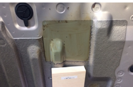
木製シムを固定する場所のツールは剥が して下さい。
