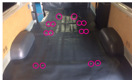
6ヶ所すべてに付属のM8×60mm ボルトを使用して下さい。 M8 ボルト・スプリングワッシャー・平ワッシャーの順で使用して下さい。 純正荷掛けフックと一緒に4ヶ所、純正荷掛けフック無しで2ヶ所固定して下さい。
