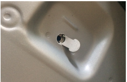
付属のインプルナットを入れ、インプルナットのステーをテープなどで固定して下さい。
