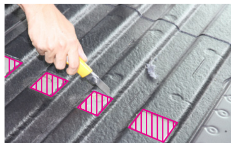
接面のタールを剥がして下さい。
