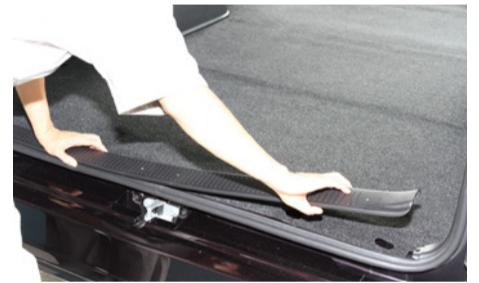
スライドドアステップカバー・エンドカバーを外して下さい。
