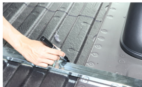
後部用角パイプフレームを仮合わせし、フロアタールと接する部分をマークして下さい。
