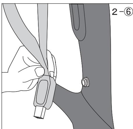
2-⑥ 固定ベルトを使用しない時はマグネットボタンに取り付けてください。スライドドアやリアゲートへの挟み込み防止になります。
