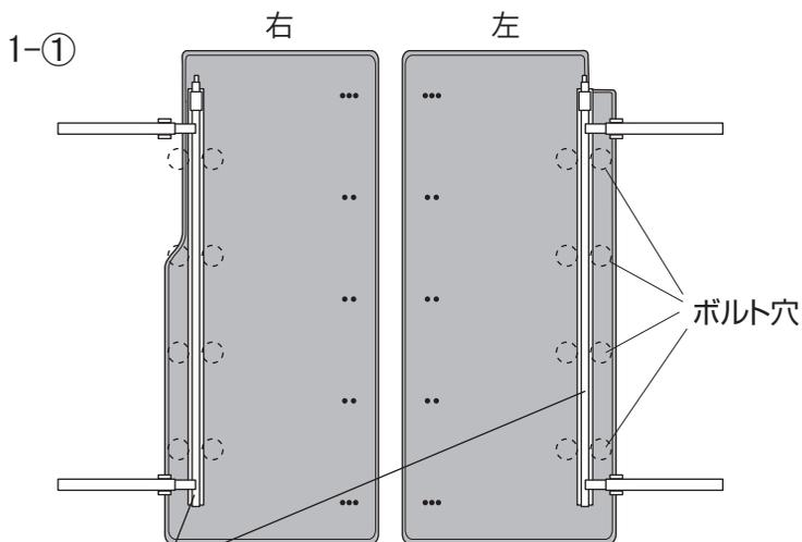
1-① 左右のベッドマット裏面に、ベッドフレームAを付属のナベP=3 (5×37) 16本で固定してください。
