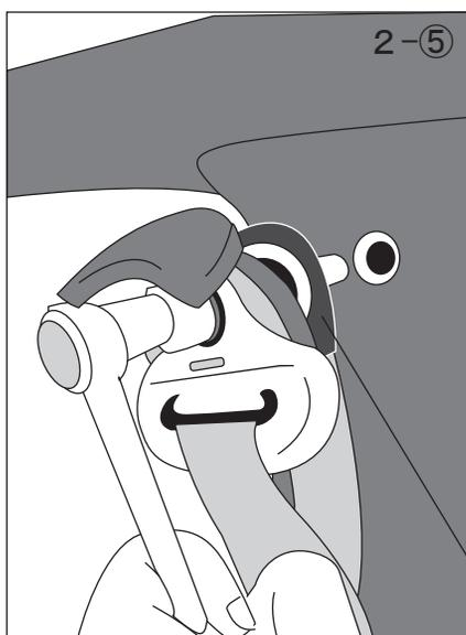
2-⑤ Cピラーを車両に戻し、前側ベッド固定ベルトをセカンドシートベルトアンカーボルトと共締めしてください。
