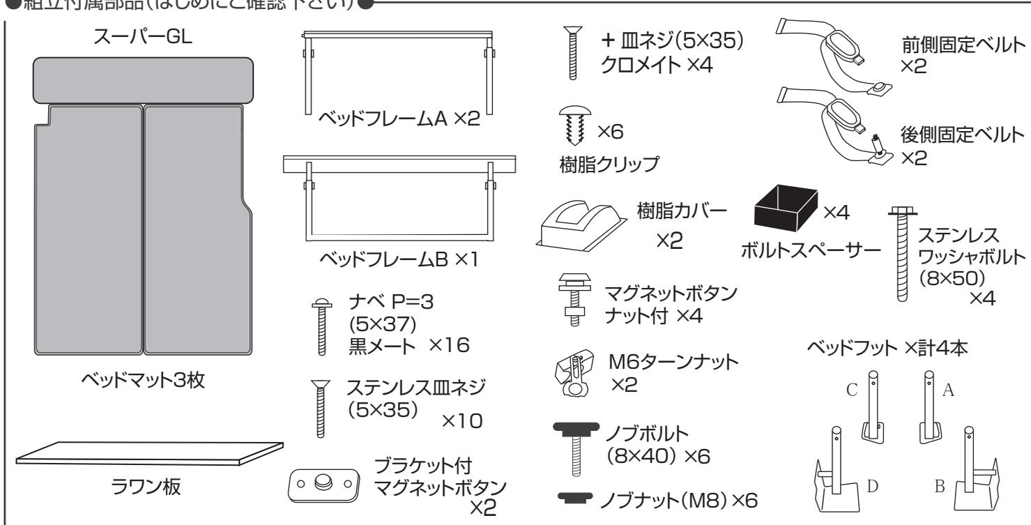
●はじめにご用意頂く物：プラスドライバー、8mm、12mm、14mmのボックスレンチ、5.5mmドリル刃、10mmドリル刃、電動ドリル
