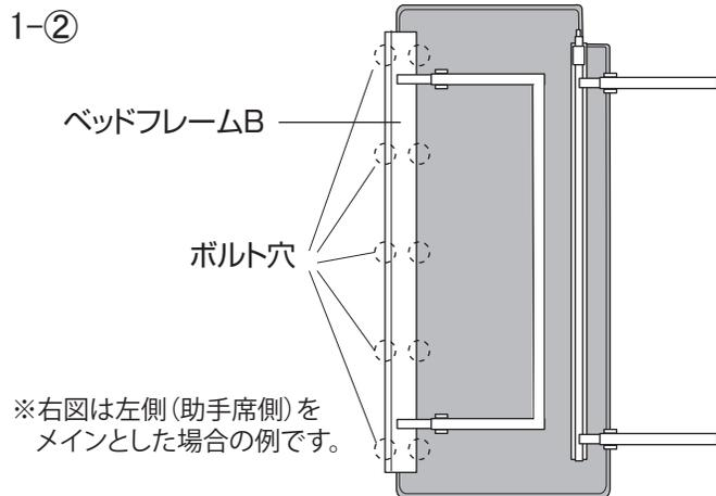
1-② メインに使用するマットを左右より決め、ベッドフレームBを付属のステンレス皿ネジ (5×35) 10本で固定してください。
