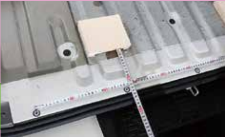
先の手順で外したエンドパネル固定ボルトの位置を基準に木製シムを仮置きして下さい。
