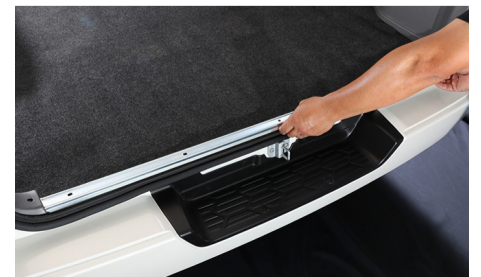
カーペットを戻し②で外したエンドパネルを元に戻しボルトで固定して下さい。
