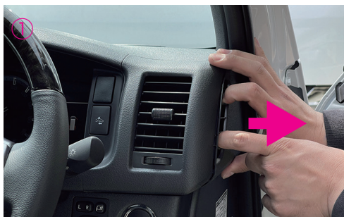
① インテリアサイドパネル右を外してください。
