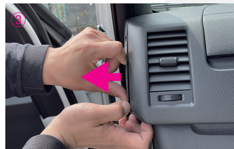
③ インテリアサイドパネル左を外してください。
