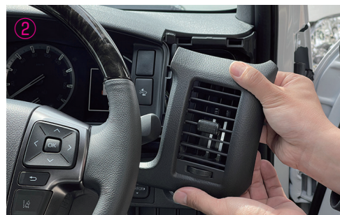
② エアコン吹出し口(右)を手前に引っ張り外してください。
