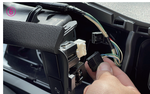
⑥ パネルを取り外すために、接続されているカプラーを外してください。
