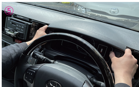
⑤ メーター周りのパネルを外して手前側に引っ張り、外してください。
