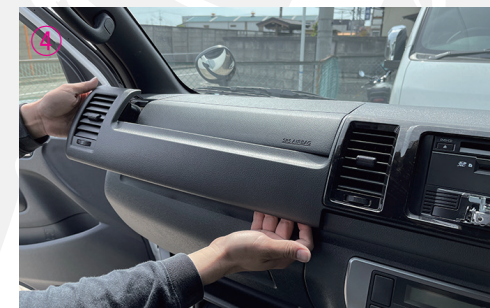
④ インテリアパネル助手席側(大)を手前側に引っ張り、外してください。
