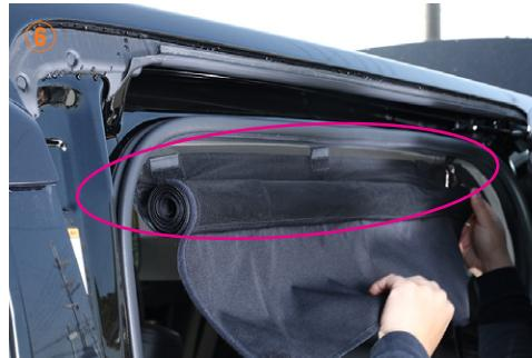
赤枠の部分をマジックテープ(3ヵ所)で⑤の写真の様に固定します。
