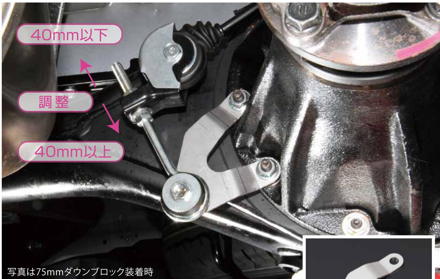
リアブレーキの制動力を調整するバルブですが、純正ブラケットのままだと、調整幅に限りがあり、ローダウン車に対応出来ません。
