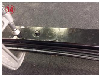
センターボルトを仮止めして下さい。この際、画像⑤で外したナットを使用して下さい。
