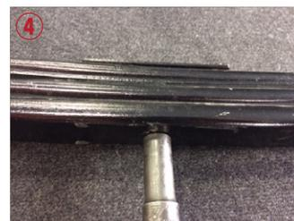
センターボルトのナットを外し、リーフを分解して下さい。
