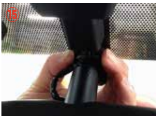
⑮ ラインカバーを取り外して下さい。
