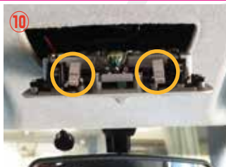
⑩ ○の位置にピンがありますので押さえながら外して下さい。無理やり外すとピンが折れやすいので注意して下さい。
