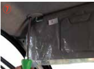
⑦ プラスドライバー#3を使用してサンバイザーを取り外して下さい。
