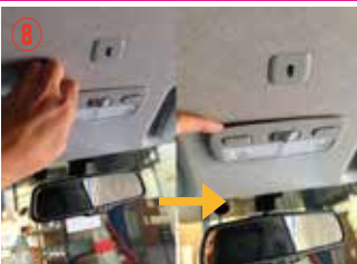
⑧ マップランプのカバーに爪を入れて少し浮かせて下さい。
