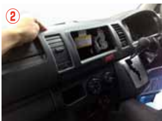
② インstrumentパネル(メイン部)を取り外して下さい。
