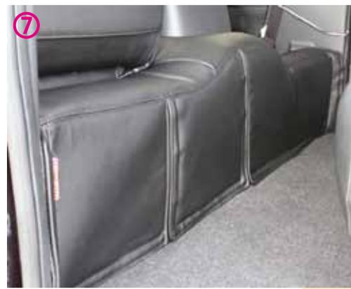
5. リアエンジンルームカバーを取り付けた状態です。センターコンソールを②→①の手順で取付ければ完成です。
