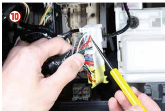
⑨～⑫ 4 型前期車用 (2013 年 12 月 ~ 2017 年 12 月) の場合 ジャンクションボックス側に配線した赤・青・灰の 3 本を別紙の拡大図を参考に配線して下さい。
