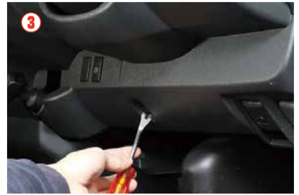
②～④ 次に運転席側のハンドル下にあるインストパネルを外し、浮かせて下さい。
