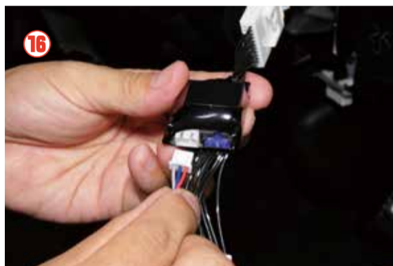
⑯ ⑦で固定したミニカプラーをミラークローズキットのミニカプラーオスに差し込んで下さい。
