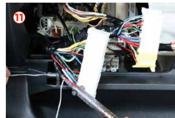
⑨～⑫ 4 型前期車用 (2013 年 12 月 ~ 2017 年 12 月) の場合 ジャンクションボックス側に配線した赤・青・灰の 3 本を別紙の拡大図を参考に配線して下さい。
