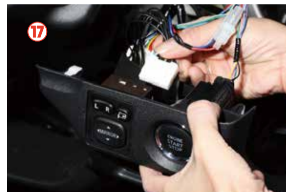
⑰ 本ユニットより出ているカプラーをミラースイッチに差し込んで下さい。②～④で浮かせたインストパネルを元に戻し作業は完了です。
