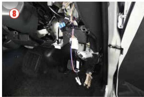
⑧ ⑦で固定したミニカプラー配線を助手席側のジャンクションボックスまで配線して下さい。
