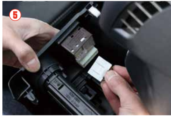
⑤ ミラースイッチ裏のカプラーを外します。
