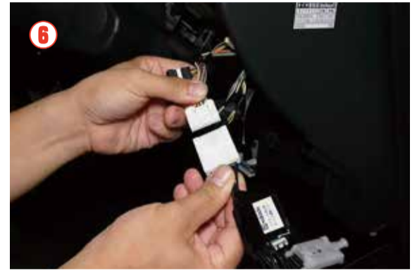
⑥ 外したカプラー (車両側) にミラークローズキットを取り付けます。
