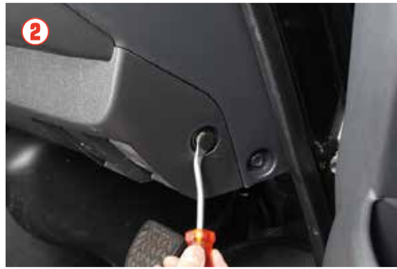
②～④ 次に運転席側のハンドル下にあるインストパネルを外し、浮かせて下さい。
