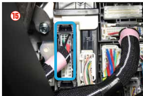
⑮ ミラースイッチ裏のカプラーを引き青と灰の2本をジャンクションボックス別紙拡大図を参考にハンダで接続して下さい。
