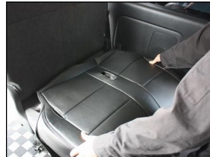
③カバーの左右を間違えないようにして、座面前側に引っ掛けるようにしてかぶせます。
