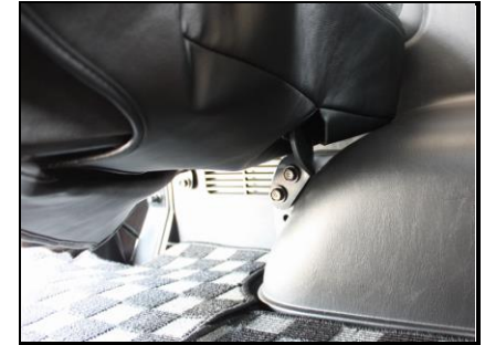
⑮カバーの穴を通したら、ステーを元に戻してボルトで固定します。
