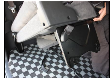
⑥座面をはね上げ、折りたたみの脚をたたむなどして、座面全体にカバーを取り付けていきます。
