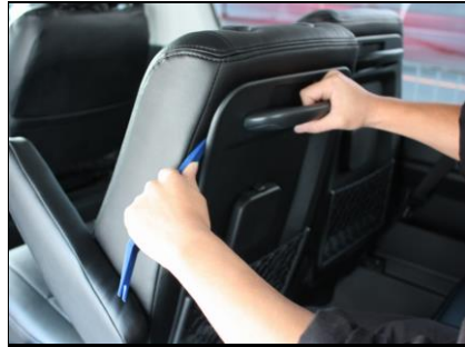
⑬裏側のボードの辺りでだぶついた箇所がある場合はヘラを使用してボードの中に入れ込んでください。
