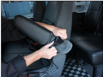
⑪アームレストにカバーを取り付けます。ラインを合わせ先端までしっかりと入れ込みます。
