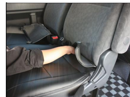
②座面と背もたれの間のカバーを入れ込み、裏側から引き出します。
