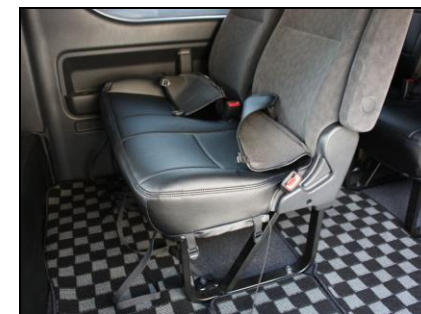
①1列目と同様にシートのラインがずれない様、座面カバーをシートにかぶせます。
