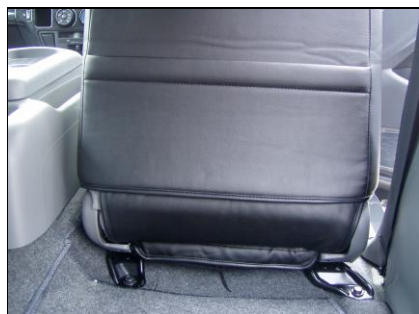
④③で入れ込んだ部分を後ろから引き出し、マジックテープで固定します。
