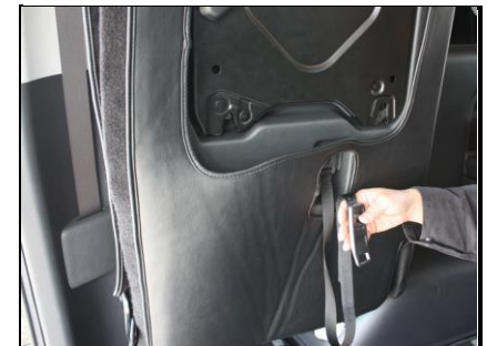
⑦座面の表側、裏側にカバーをかぶせたら、裏側の穴からシートをはね上げ時に固定するベルトを通します。
