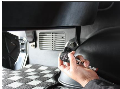
①座面前側にあるステーをとめている2本のボルトを工具を使用して取り外します。
