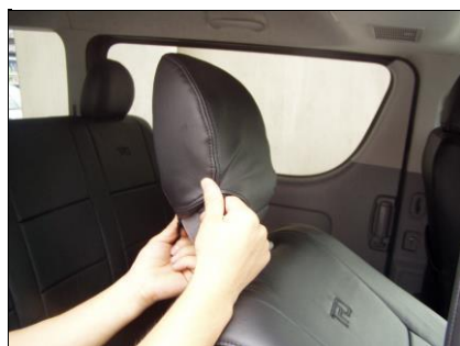
②ヘッドレスト本体を押しつぶしながらカバーに入れ込んでいきます。縫い目の部分に力が掛かりすぎるとカバーが破損する恐れがありますので、作業は慎重に行ってください。
