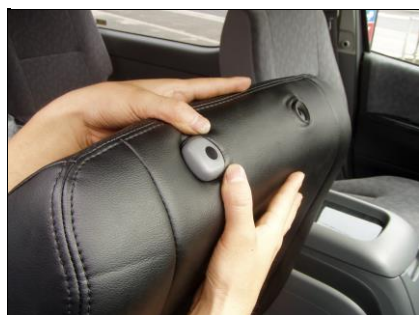
⑤ヘッドレストの台座部分を穴から取り出します。生地の手引きを利用して横から潜り込ませるように取り出してください。無理に取り出すと破損の恐れがありますのでご注意ください。
