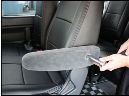
⑩取り外したアームレストを元に戻します。
