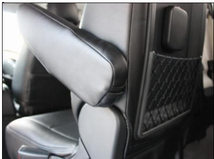
⑫アームレストの後ろ側でマジックテープでとめて固定します。
