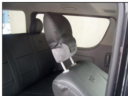
①ヘッドレストカバーの前後を確認してからかぶせます。生地の高い方が前になります。
