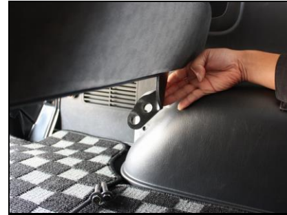
⑫ステーを外した状態です。可動するようになっており、カバーの穴に通すようにします。
