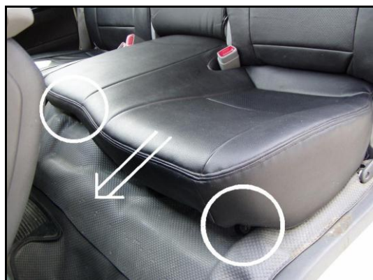
⑤○印2箇所のボルトを外して、シートを手前に 引いて座面部を取外します。
