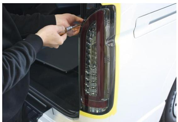
カプラーを差し込み、ネジを締め付けオール LED&BAR テールランプを取り付け完了です。
