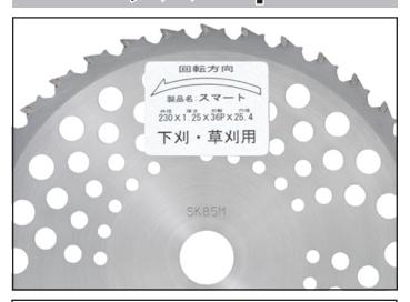
本製品、スマートは従来の刈払チップソーと 比較し、チップ研磨側面すくいリード角を鋭角 であり、切味向上しつつ強度と寿命性は制限刃 を取入れ尚且つ両ツバ形状にてチップ脱落しに くい設計をしております。
