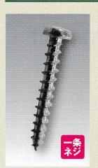
天然木の様な弾力性が無く内部が柔らかくねじがききにくいMDF、パーチクルボード用に開発されたねじです。谷径がねじ外径に比べて、極端に細くできており、山と谷の差が大きく、ピッチも粗く出来ています。細い谷径が、柔らかい材質を押し潰さずにソフトに入り込み、表面積の広いねじ山は、幅広く雌ねじをたてていきます。また、ねじ山の先端方向側は、鋭角な角度になっている為ねじ込みトルクが小さく、相手材に過剰な負荷がかからない。反対に頭部側のねじ山角度は、鈍角に出来ており、締め付け後、相手材を大きく捕らえる為に引き抜き強度が非常に高い。ねじの山と谷の差、頭側、先端側のねじ山角度の違いこの特徴により、抜群の保持力とねじ込み低トルクを実現しました。ねじ先端の頂点からねじがたっているので、すぐ相手材に食い込み、作業性が良く、いきなり相手材を押し潰すような事が起こりません。従来のねじでは、「ねじが効かない」「締結後抜けてしまう」など、問題がなかなか解消されなかった"MDF"パーチクルボード"に最適な専用ビスがこの"パーチビス"になります。(実用新案登録)
