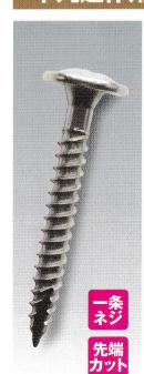
ねじ部は、カット付コーススレッド。頭部は、抑えを効かす シンワッシャー。半丸造作ビス、半丸形状の樋受けの施工 専用ねじです。造作とは、木工事において、骨組みが完成し た後に施工される内外の木工事全般のこと。敷居、鴨居、 長押、畳寄せ、廻縁、幅木、額縁、見切材などを「造作材」 と言います。屋根部・外壁に使用するので、耐食性を重視し たラスパート処理品です。
