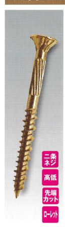
ねじ部は、高い山と低い山の2条ねじの先端カット付きです。首下ねじ 無し部に 短いサイズには1つ、長いサイズには2つ、ローリング加工 による"ツイストローレット"がついています。打ち始めの相手材への 食いつきが良く、安定した締結作業がスピーディに行えます。また、 ねじ無し部が相手材にねじ込まれる際に発生する摩擦を"バカ穴"を 開けることでトルクを軽減することが出来ます。
