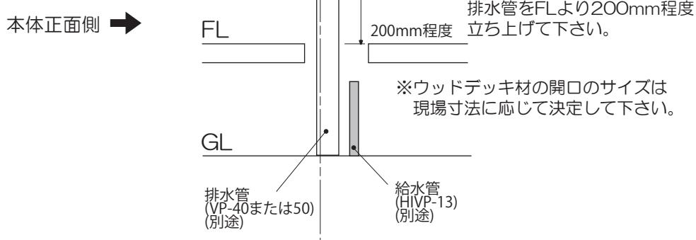
【2】本体を仮置きし、現場寸法に応じて給水管を延長します。
