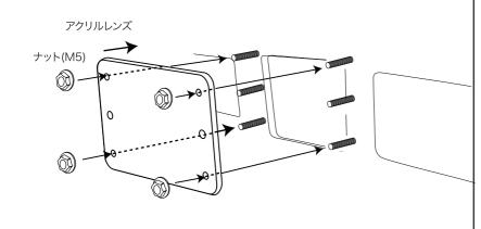
3. フロントバンパーに付属のアクリルレンズをナット (M5)を使用して取り付けてください。
