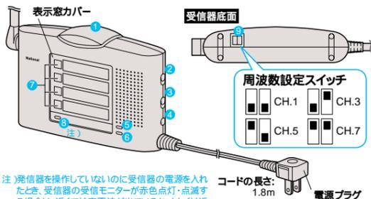
注) 発信器を操作していないのに受信器の電源を入れたとき、受信器の受信モニターが赤色点灯・点滅する場合は、近くで妨害電波が出ているか、もしくは近くで特定小電力無線設備が使用されている可能性があります。受信器の使用場所を変更したり、周波数チャンネルを変更して受信モニターが赤色点灯・点滅しない場所に設置してください。
