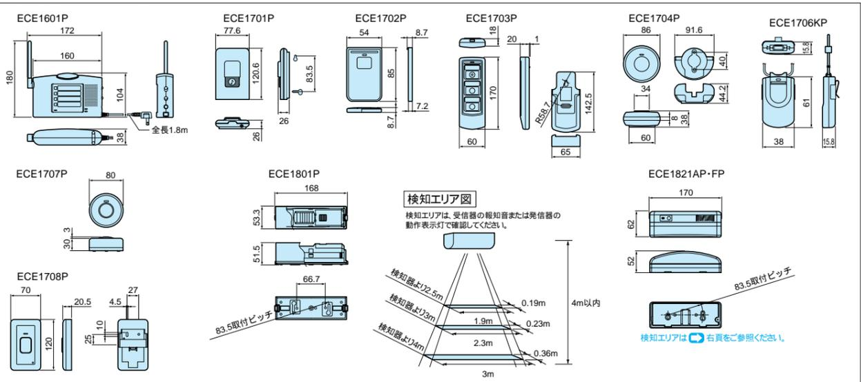
小電力型ワイヤレスコール熱線センサー送信器(屋側用)
