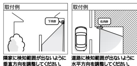
熱線センサーは、物体(地面や壁など)の温度と人の温度の「温度差」を検出します。
