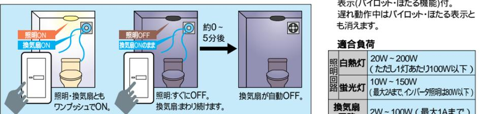
電子トイレ換気スイッチのランプ点灯状態(WTC5383W)
