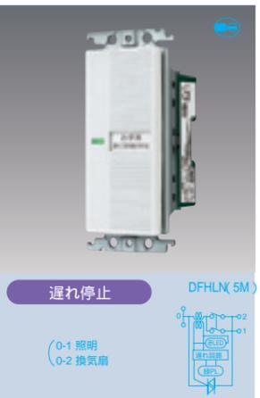
ワンタッチで照明と換気扇が同時にON。スイッチをOFFにすると、照明はすぐさま消灯。換気扇は一定時間まわり続け、その後自動OFFします。
