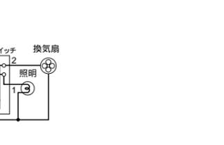
窓のあるトイレの1室換気(一時動作スイッチ スイッチON後、一定時間後自動OFF / 遅れ停止スイッチ スイッチOFF後、一定時間後自動OFF)
