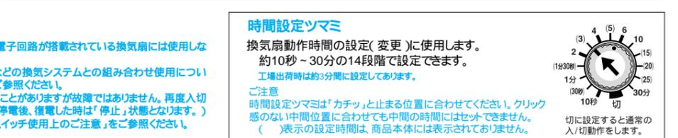
窓のないトイレの1室換気(遅れ停止スイッチ スイッチOFF後、一定時間後自動OFF)
