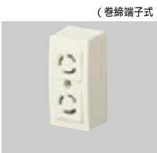
㊦WK2312W 希望小売価格 1,280円 税抜 接地2P15A引掛露出 ダブルコンセント(送り端子付) 15A125V ㊦
