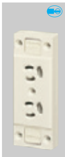
㊦WK1562 希望小売価格 800円 税抜 露出抜け止め接地ダブル コンセント(仮設用) (フル端子) 15A 125V
