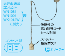
㊦WN1001 希望小売価格 3,250円 税抜 リーラーコンセント(15Aキャップ付・1.2m) 15A 125V 心線:1.8mm2(0.12mm160心) 全長約0.6~1.2mまで調整可能 *WG1200を使用する場合は6A以内 でご使用ください。
