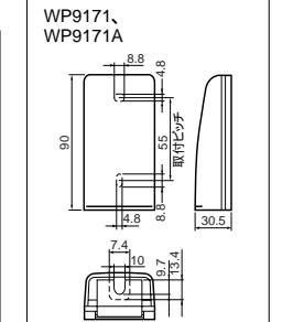
防雨引込カバー.....電力線の引き込みに電線径の大きな電力線が入線できます。
