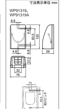
小形防雨入線カバー.....TV・電話線の引き込みに入線本数が少なく、露出取付の場合におすすめします。
