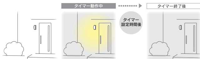
①明るい時は消灯しています。 ②暗くなると点灯します。 ③タイマー終了後に消灯します。
