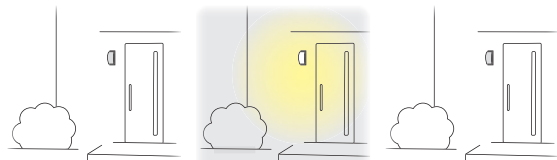
①明るい時は消灯しています。 ②暗くなると点灯します。 ③明るくなると消灯します。
