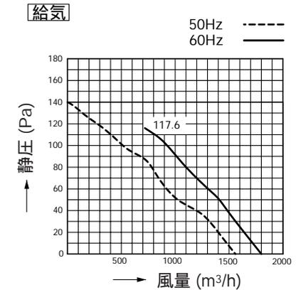
特性表 モーター結線を入れ替え羽根を逆に取付けることにより給気にもなります。
